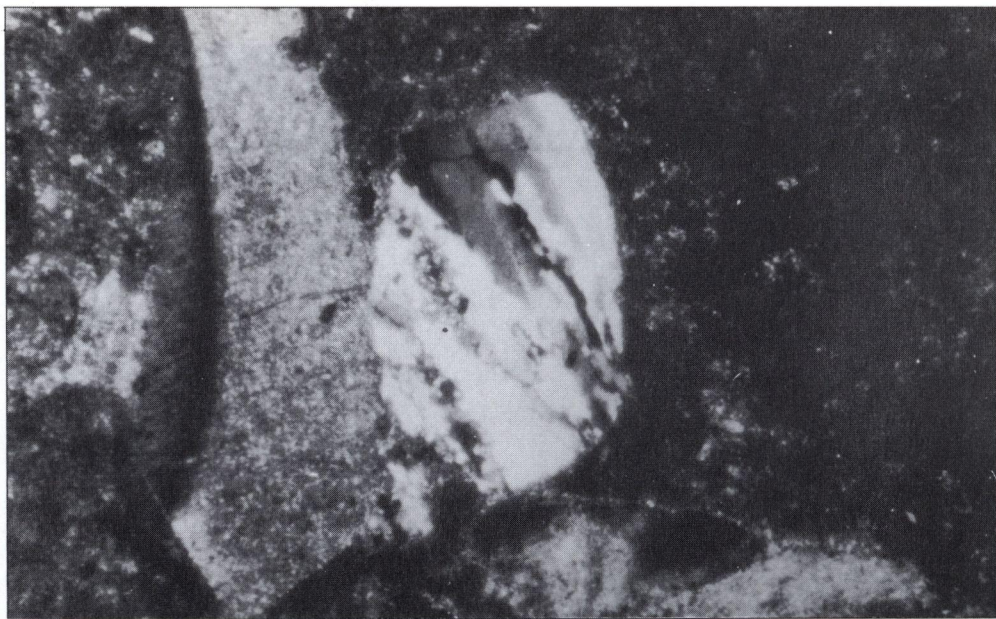
b. Μεγάλο μόριο από στρογγυλεμένο πολυκρυσταλλικό Quartz δίπλα από ένα θρύμμα από όστρακο. Παρατηρείται η μεγάλη ποσότητα από τσιμέντο άμορφου ασβεστίου που εξασφαλίζει μικρότερη πωρότητα από εκείνη που παρουσιάζει το δείγμα A (βλ. φωτοδιάγραμμα Fig. 7). Nicols+, 65X.
